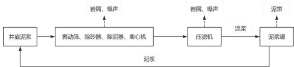
图2-8 泥浆循环、处置工艺流程及产污环节图
